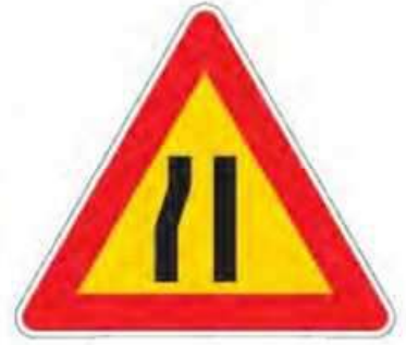
FIG. 385 ART. 31 STRETTOIA ASIMMETRICA A SINISTRA
